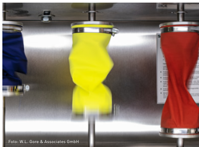
Belastungstest: Die Materialien werden bei extremen Temperaturen immer wieder zusammengedrückt und gedehnt.
